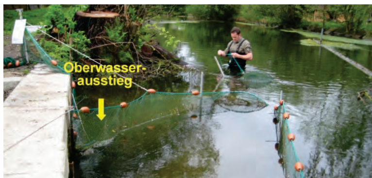
Reusenbefischung zur Funktionskontrolle einer neu errichteten Fischwanderhilfe
