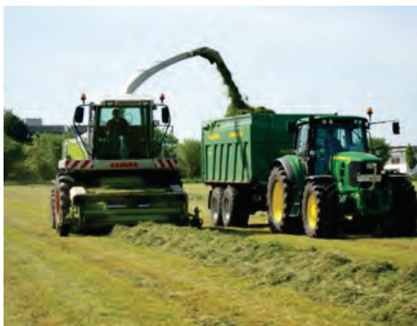
Grasernte mit Online-Ertrags- und Feuchtemessung am Feldhäcksler
